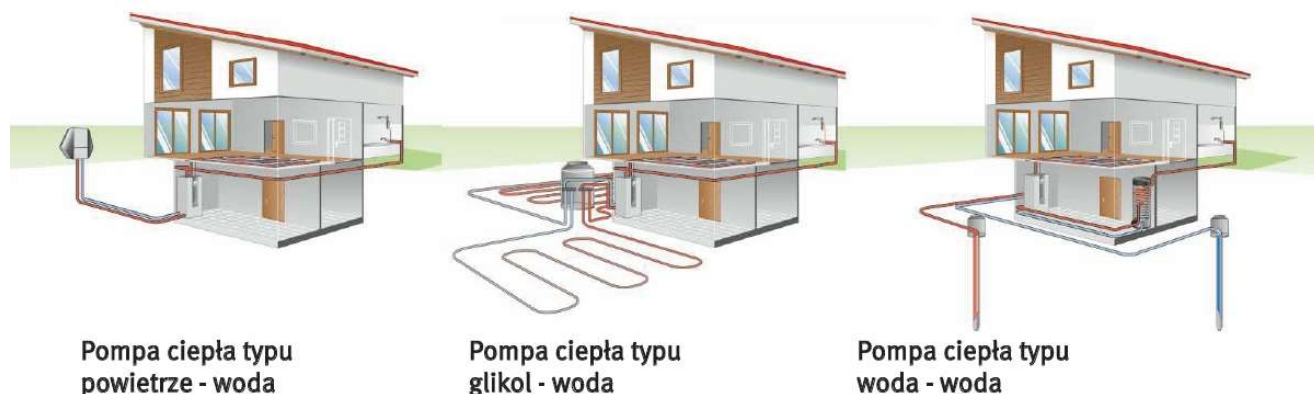
Rys 29. Rodzaje stosowanych pomp ciepła Źródło: www.pompyciepla.pl
